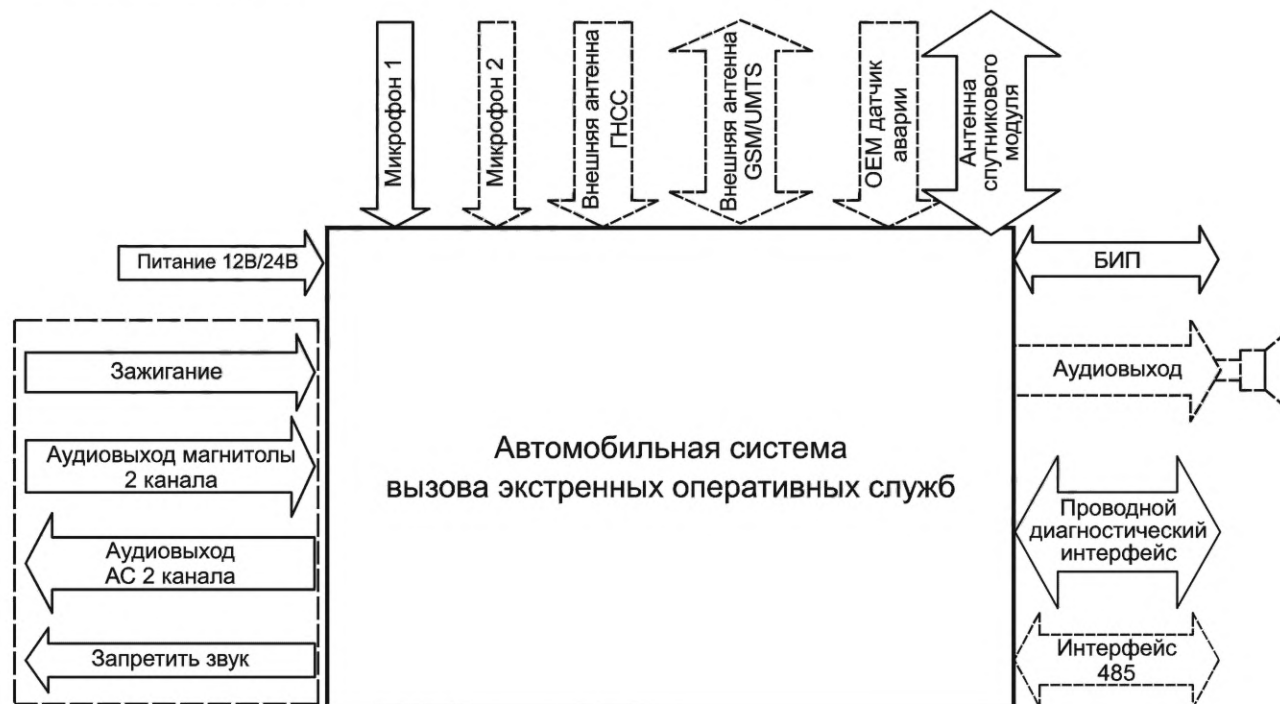
Рисунок Ж.1 — Пример подключения УСВ к аудиосистеме транспортного средства
