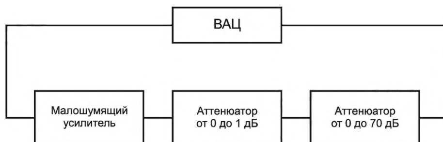
Рисунок В.2 — Схема калибровки тракта
