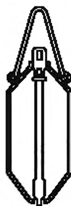
Рисунок 7 — Донный или зонный пробоотборник (вид в разрезе)
