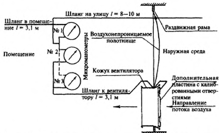
Рисунок 5 — Схема монтажа установки при проведении испытаний на воздухопроницаемость
