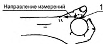
1 — датчик (расположен за большим пальцем кисти руки)
