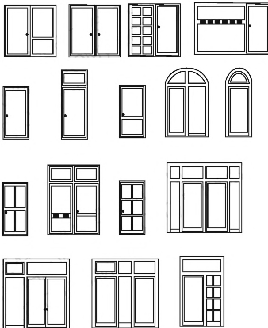
Рисунок А.1 — Примеры архитектурных рисунков дверных блоков
