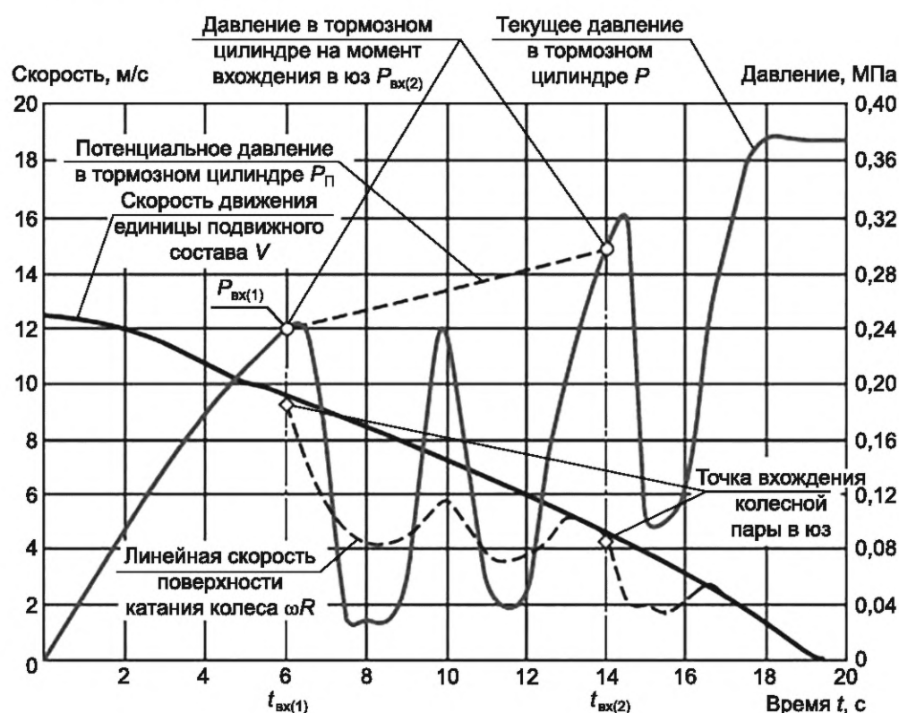
Рисунок 1 — Результаты испытаний по определению коэффициента эффективности использования сцепления
