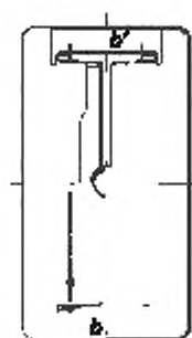
Рисунок Б.2 – Двойной Т-образный разводящий канал (например, для изучения прочности границы проплавления)
