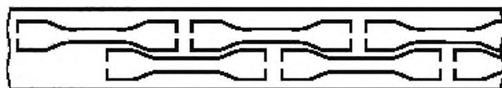
Рисунок 15 — Образцы, вырубленные ножом с выемкой
