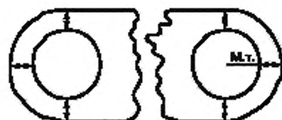
Рисунок 11 — Измерение толщины оболочки (плоский кабель с разделенными жилами)
