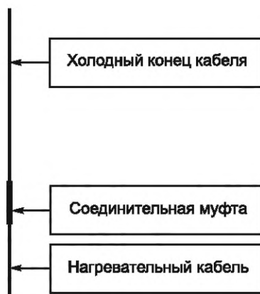
Рисунок 1 — Типовое расположение компонентов при испытании соединительной муфты
