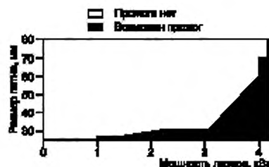
Рисунок F.13 — Стойкость к разрушению листа оцинкованной стали толщиной 1 мм от 10 с экспозиции расфокусированного пучка во время экспериментов с использованием непрерывного лазера на иттрий-алюминиевом гранате с неодимом
