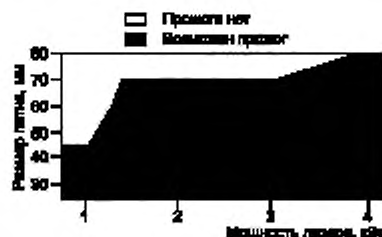
Рисунок F.14 — Стойкость к разрушению листа оцинкованной стали толщиной 1 мм от 100 с экспозиции расфокусированного пучка во время экспериментов с использованием непрерывного лазера на иттрий-алюминиевом гранате с неодимом
