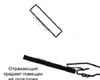
Рисунок В.4d — Отражающий предмет пересекает пучок лазера
