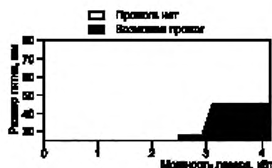
Рисунок F.15 — Стойкость к разрушению листа оцинкованной стали толщиной 2 мм от 10 с экспозиции расфокусированного пучка во время экспериментов с использованием непрерывного лазера на иттрий-алюминиевом гранате с неодимом
