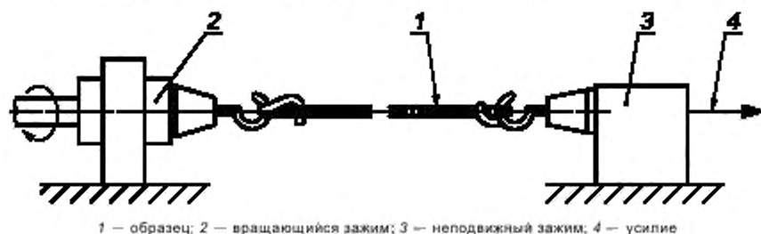
Рисунок 6 — Устройство для испытания на отслаивание
