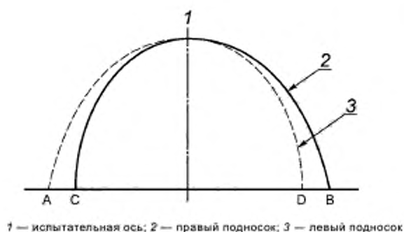
Рисунок 2 — Определение испытательной оси
