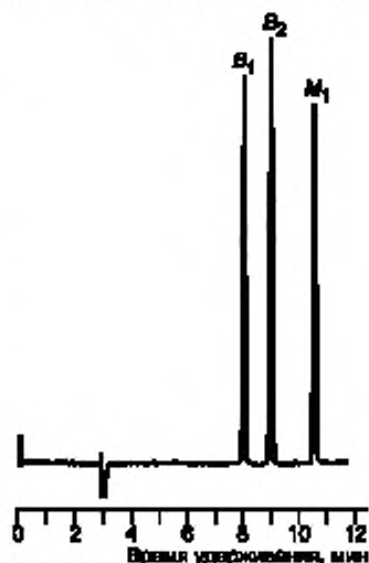
Рисунок 2 — Хроматограмма рабочего раствора смеси афлатоксинов
