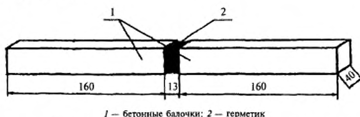
Рисунок 4 — Образец деформационного шва для определения показателя выносливости
