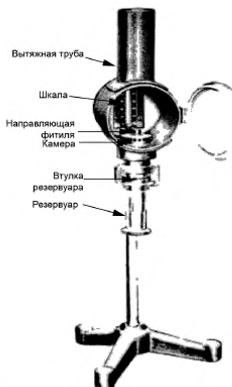
Рисунок 1 — Лампа для определения максимальной высоты некопящего пламени (ручной аппарат)
