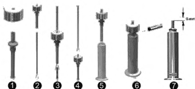
Рисунок 5 — Пошаговая установка фитиля
