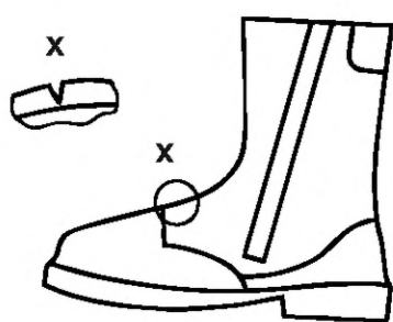
a) Глубокие трещины в верхе
