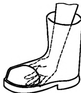
ф) Повреждение подкладки; острые края
