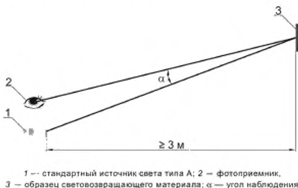
Рисунок Б.1 — Схема измерения удельного коэффициента световозвращения (вертикальный угол наблюдения)
