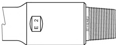
а) стандартное расположение желобка и заводская маркировка на трубе стандартной массы класса E;
