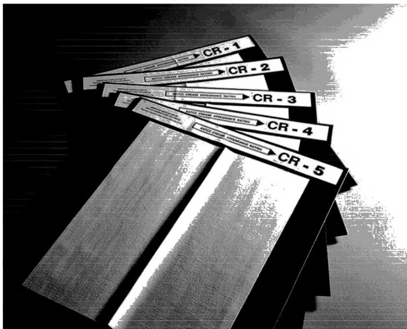
Рисунок 3 — Стандартные пластиковые эталоны складок AATCC
