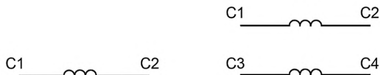
Рисунок 18 — Компенсирующая обмотка, один и два элемента
