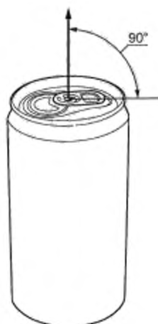
Рисунок В.7 — Иллюстрация измерения прочности при механических нагрузках на растяжение
