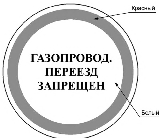
Рисунок Е.3 — Знак «Газопровод. Переезд запрещен»
