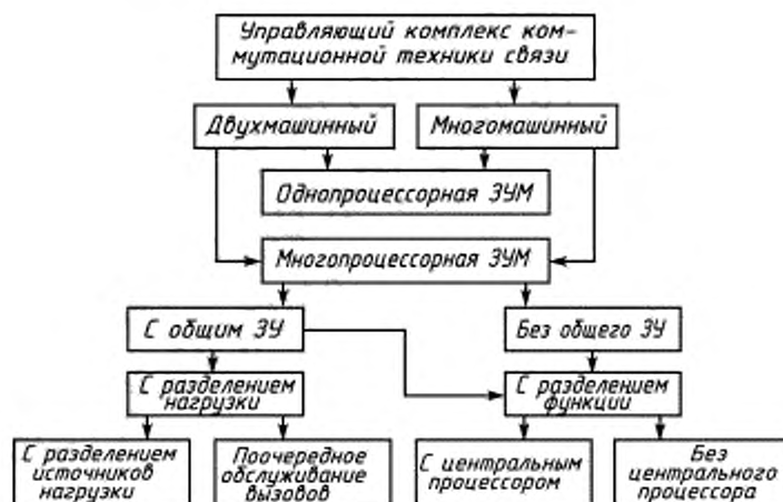
Схема классификации управляющих комплексов коммутационной техники связи по принципу построения и режимам работы
