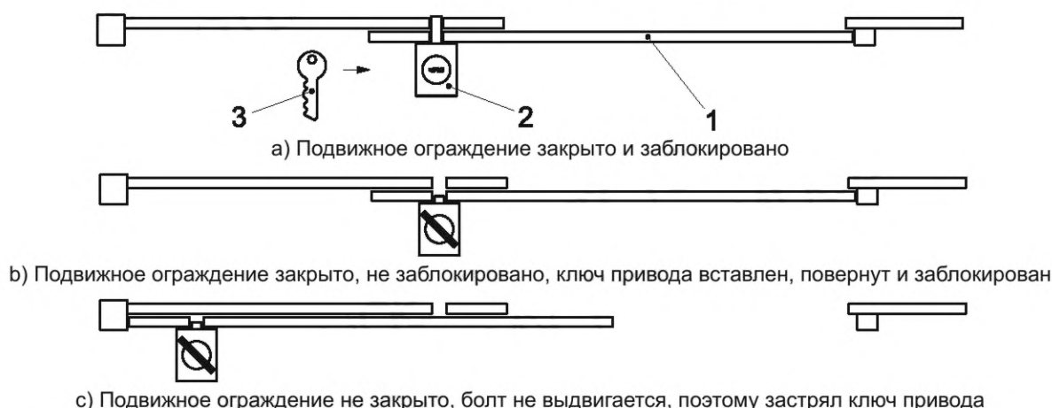
Рисунок В.3 — Принцип блокировки заблокированного ключа — Шаг 1
