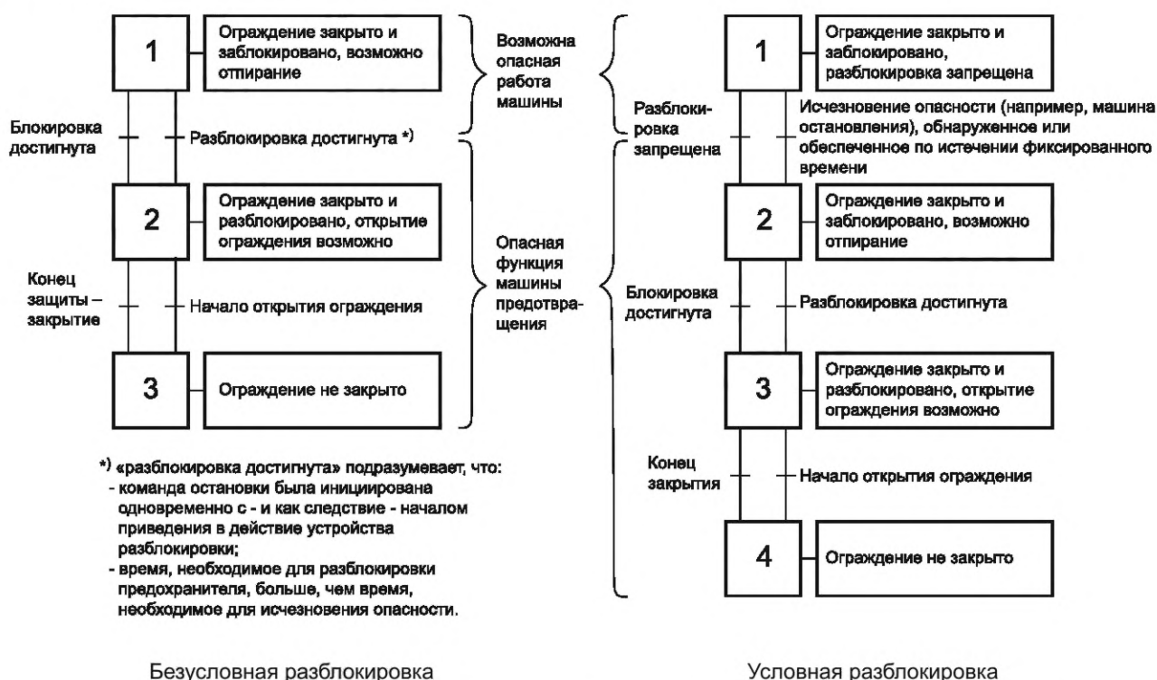
Рисунок 4 — Функциональные схемы блокировочных устройств с защитной блокировкой
