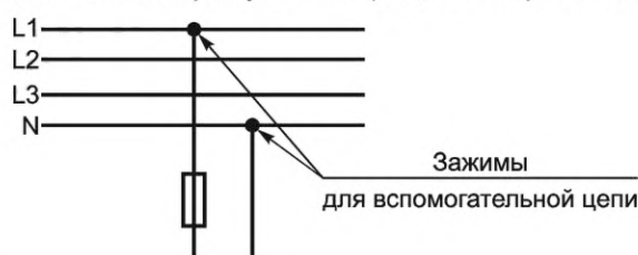
Рисунок 557.1 — Вспомогательная цепь с питанием непосредственно от главной цепи
