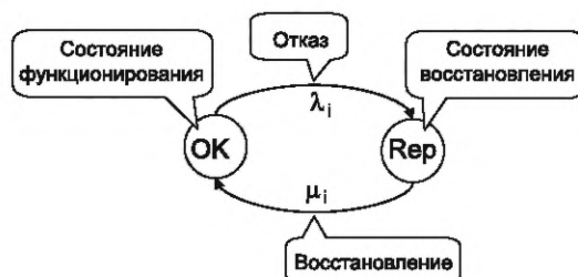
Рисунок 22 — Граф Маркова коэффициента готовности для простого восстанавливаемого блока
