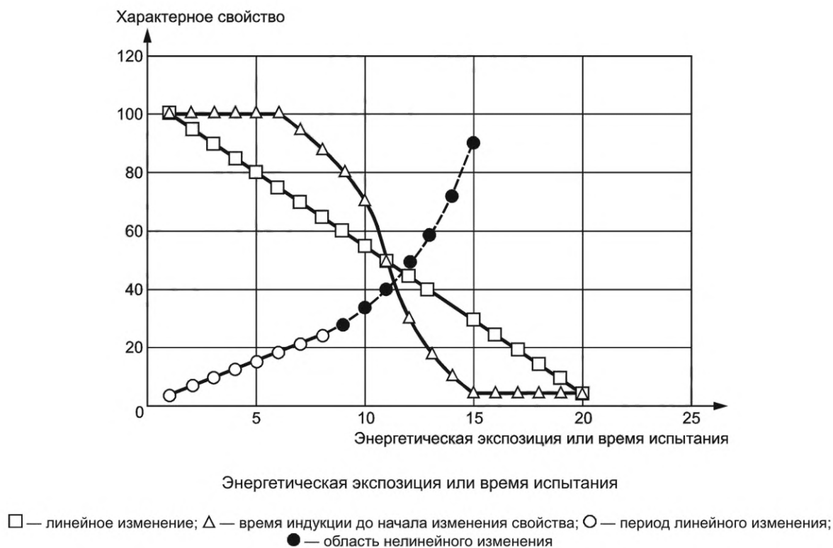
Рисунок А.3 — Стандартное поведение характерного свойства в виде функции экспонирования для референтного материала, показывающей линейное изменение, время индукции до начала изменения свойства и период линейного изменения, за которым следует область нелинейного изменения
