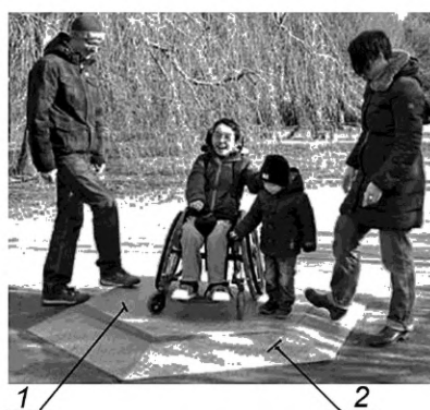
1 — платформа; 2 — основание с пружинными опорами
