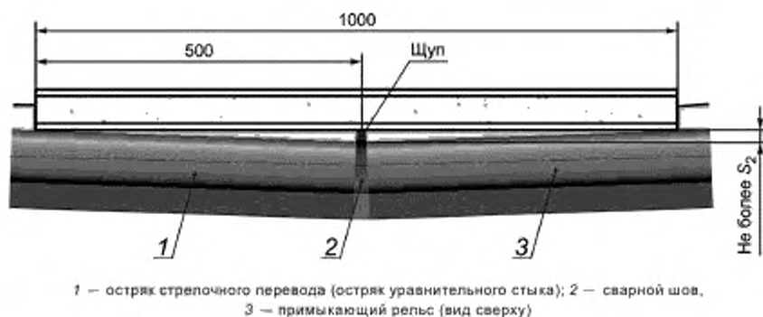
Рисунок 10 — Схема измерения отклонения от прямолинейности по боковой рабочей грани головки рельса сварного остяка (уравнильного стыка)
