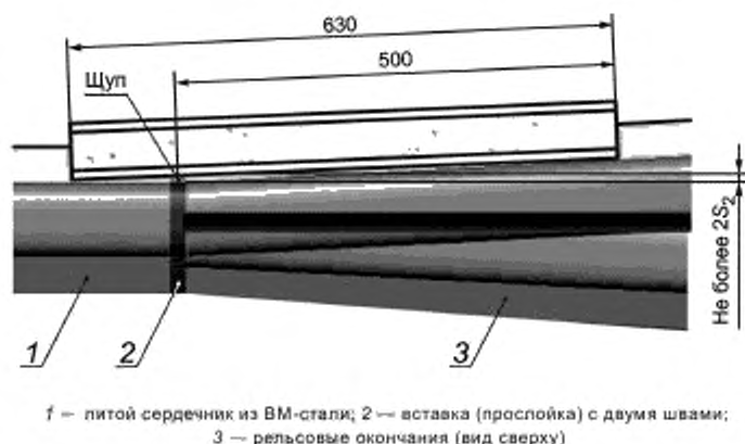
Рисунок 12 — Схема измерения отклонения от прямолинейности по боковой рабочей грани головки рельса УСК
