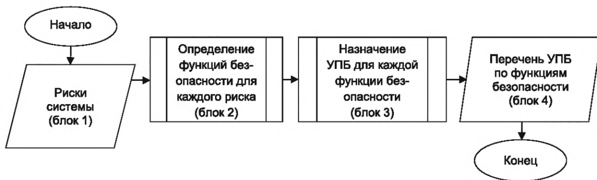
Рисунок 1 — Блок-схема обобщенного алгоритма контроля УПБ
