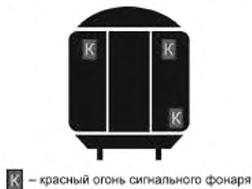
Рисунок 1 — Размещение сигнальных фонарей на торцевых стенах вагона
