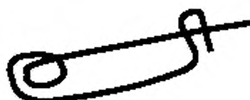
Рисунок 6 — Стальная булавка для запираания аварийного люка
