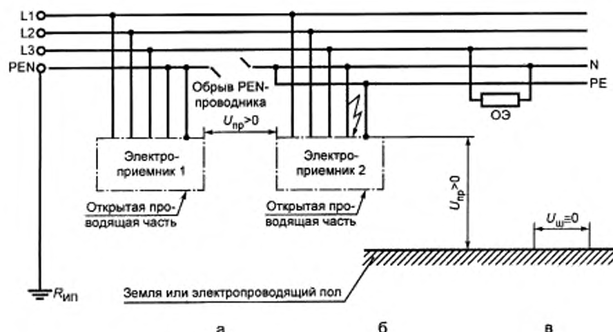
Рисунок В.7 — Сеть TN-C-S с обрывом PEN-проводника
