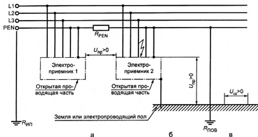
Рисунок В.3 — Сеть TN-C с однофазным замыканием на корпус
