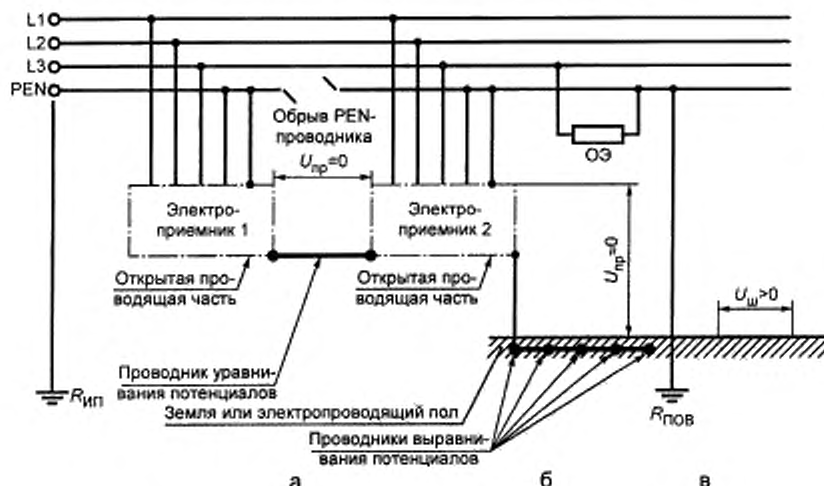
Рисунок В.2 — Сеть TN-C с оборванным PEN-проводником Имеется уравнивание потенциалов на участке а), выравнивание потенциалов на участке б). На участке в) выравнивание потенциалов отсутствует
