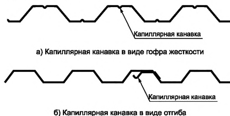
Рисунок 3 — Основные виды капиллярных канавок
