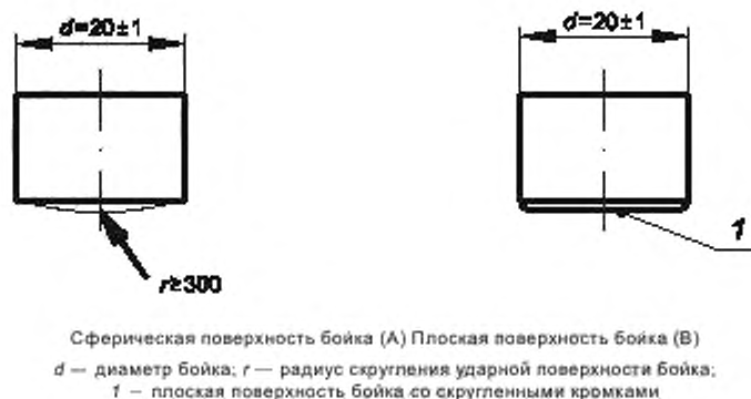
Рисунок 6 — Схема формы бойка ударника
