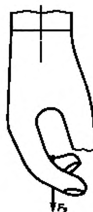
Рисунок 4 — Схема испытания фиксатора пальцев
