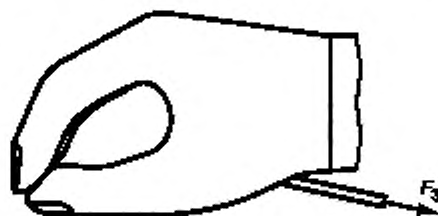
Рисунок 5 — Схема испытания механизма раскрытия пальцев кисти
