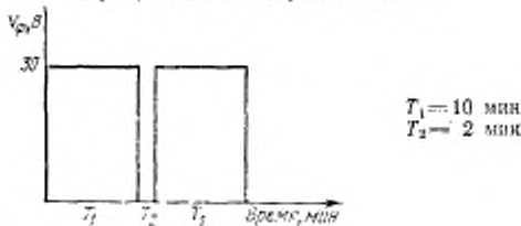
Схема формовки образцов при нормировании на напряжение 30 В
