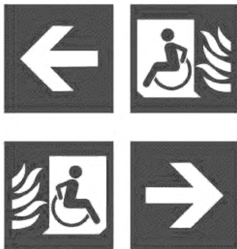
Рисунок 23 — Знак «Эвакуационные пути для инвалидов» («Выход там»)
