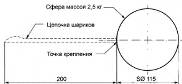
Рисунок 5 — Испытательная цепочка с образованием петли
