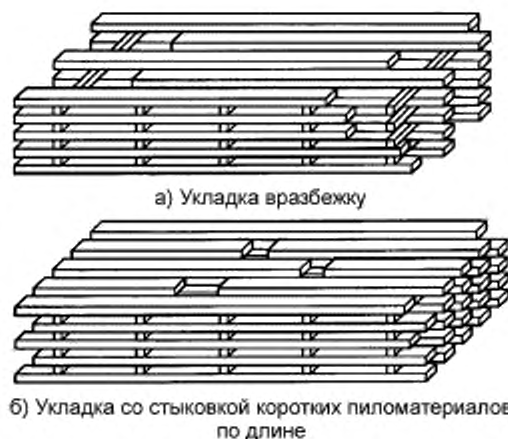
Рисунок А.7 — Способы укладки пиломатериалов разных длин в сушильные пакеты
