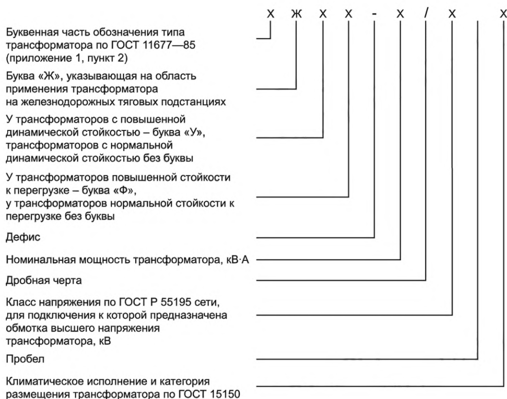
Рисунок 1 – Структурная схема условного обозначения трансформатора
