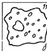
Частицы с внутренними пустотами а) губчатая (с на- б) пористая (с на- личием сквозных наличием закрытых пор) пор)
