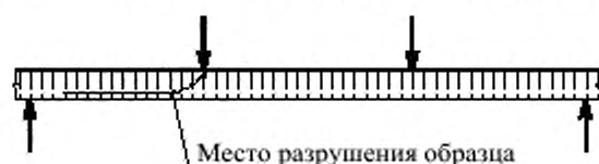
Рисунок В.5 – Типичная схема разрушения сердцевины от сдвига
