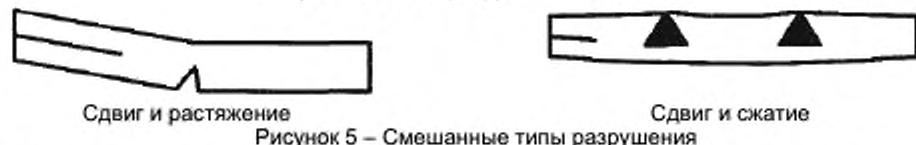
Рисунок 5 – Смешанные типы разрушения
