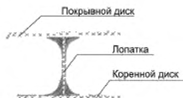
Рисунок А.6 – Крепление лопаток радиальных вентиляторов с приформовкой
