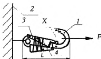
1 — основной крюк карабина; 2 — неподвижная опора; 3 — внутренняя рукоятка карабина; 4 — проволока диаметром 1—1,5 мм для закрепления рукоятки в указанном положении; P — растягивающее усилие ( 500 \pm 1 ) кгс; X — расстояние между наружной поверхностью носка крюка карабина и наружной поверхностью тыльной стороны карабина; L — длина карабина, измеренная по оси приложения нагрузки
