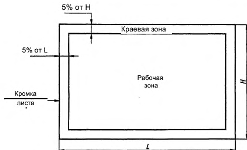
Рисунок 2 – Осматриваемые зоны стекла с покрытием конечного размера
