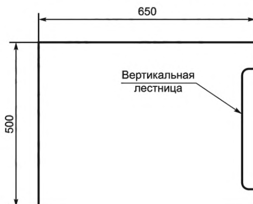
Рисунок 13 — Минимальные размеры свободного проема люка прямоугольного сечения
